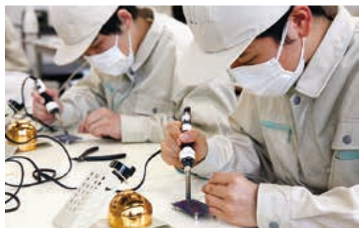
制御回路のはんだ付け
