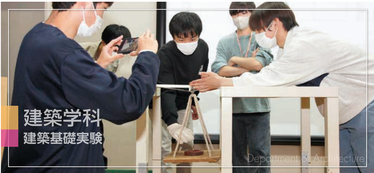
載荷板を支える人、おもりを載せる人、載荷と崩壊挙動を観察する人の3人1組で実験 (構造強度/ペーパーストラクチャー)
