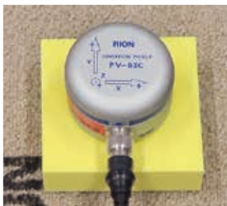
カーペットや畳上で設置共振の誤差を低減する環境振動測定方法の提案
