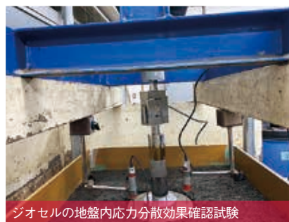
ジオセルの地盤内応力分散効果確認試験
