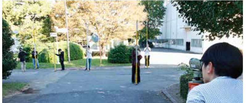
三脚に据え付けたレベルと標尺を組み合わせて、地点間の高低差を観測します。
