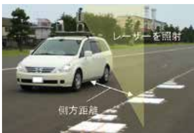
MMSによる交通総合試験路での実験 (Applanix社製LANDMarkシステム)
