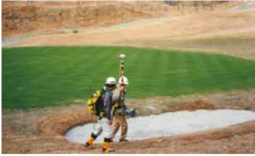
GPS誘導型測量システムによるゴルフ場の測量と画面例
