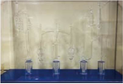
写真2 中央の二つが研究室で制作した低圧VLEの測定装置のミニチュア
