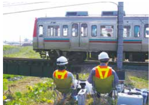
実際の鋼鉄道橋における騒音振動計測
