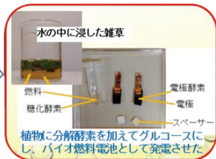
図 植物のセルロースを酵素分解して燃料にするメカニズムとバイオ燃料電池への適用
