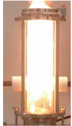
写真 燃料粉じんの爆発下限濃度測定試験の様子
