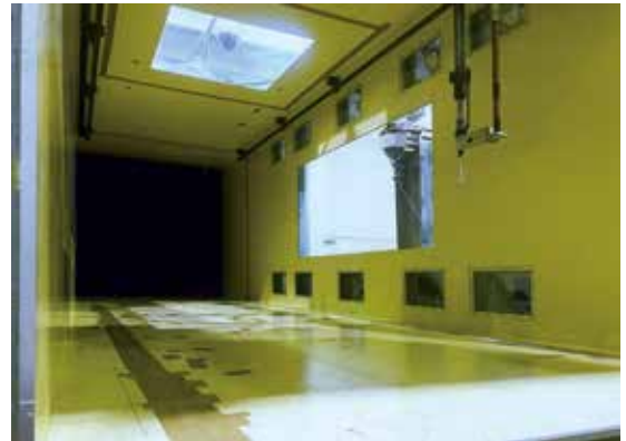
図1 大型低速風洞測定部 (2m×2m)
