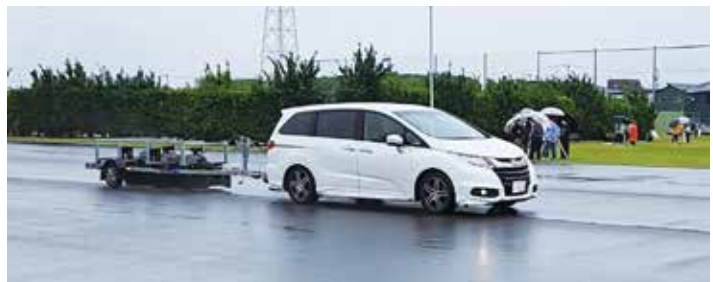
写真2 湿潤路の路面摩擦特性計測実験
