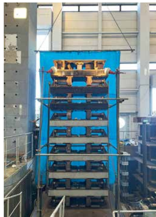
D.M.付きTMDシステムを付加した9層せん断モデル試験体
