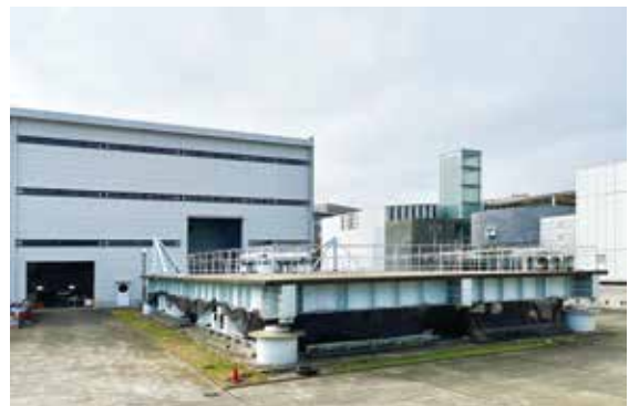
付加質量型制震装置の振動実験および大型振動台による自由振動実験
