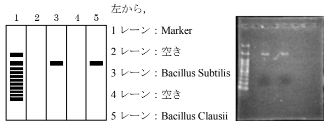
Figure 9 電気泳動結果のゲル 模式図と写真
