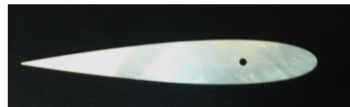
Figure 2. NACA0015 翼模型の断面
