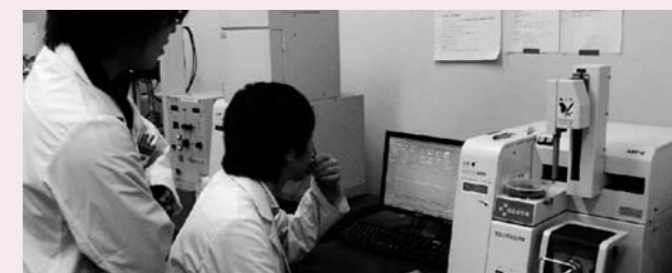
熱分析装置を用いた新規材料の熱物性測定
