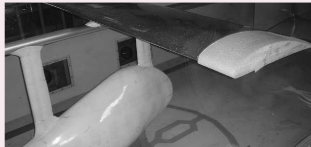
人力飛行機の風洞実験
