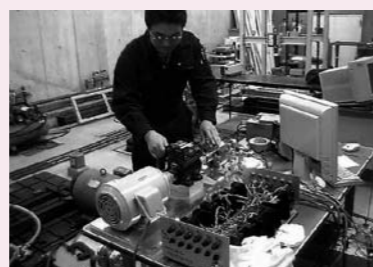
新渦電流方式動力計 永久磁石を用いた新装置の 組立風景。
