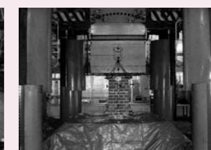
30MN大型構造物試験機を用いたレンガ組積体の圧縮実験
