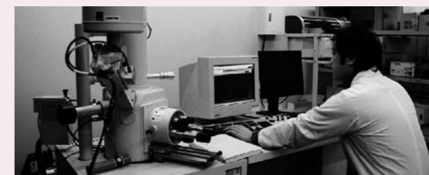
EDX装置付走査型電子顕微鏡による材料表面の観察
