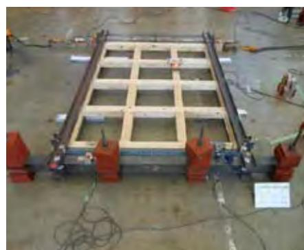
写真1. 木造面格子壁の実験
