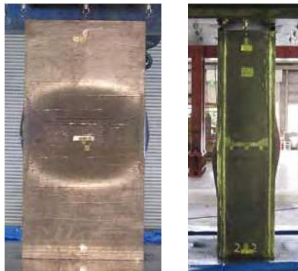
写真1. 長方形断面CFT柱の圧縮破壊状況
