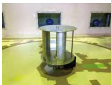
図1. 大型低速風洞に設置した垂直型風車モデル
