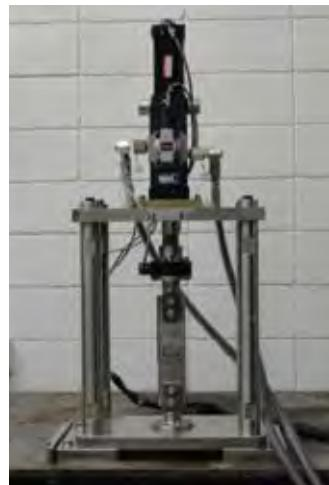
図1. スポット溶接疲労試験装置
