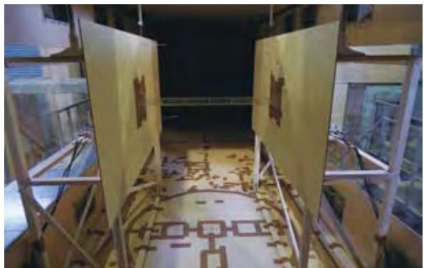
写真1. 風洞内に設置した架台と正方形角柱模型
