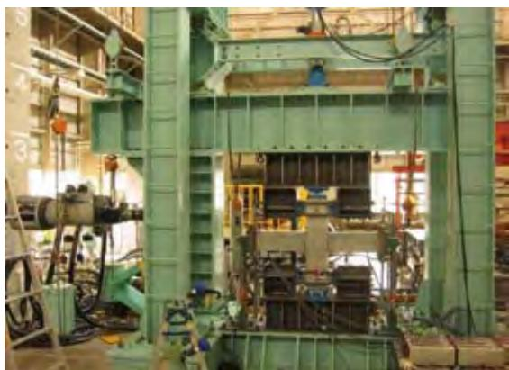
写真1. 接合部実験加力装置
