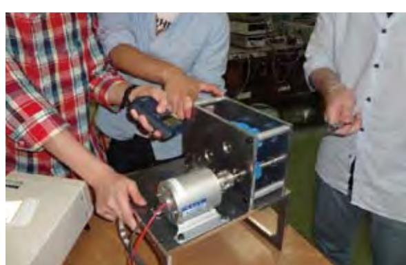
図2.発電試験の様子。最大3W程度発電した。
