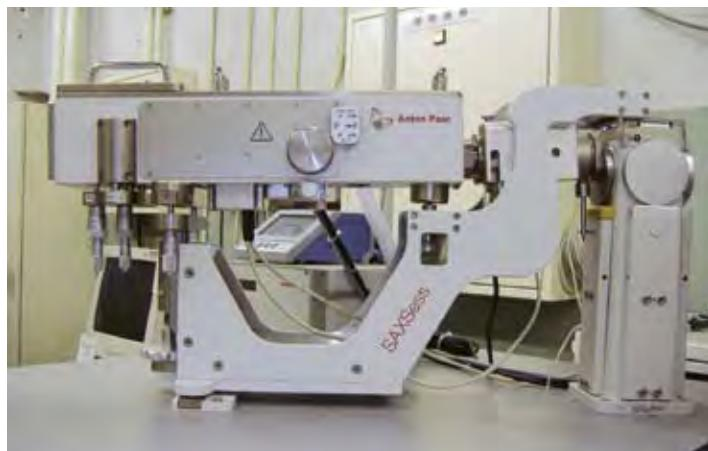
写真1. X線小角散乱装置 (SAXSess)
