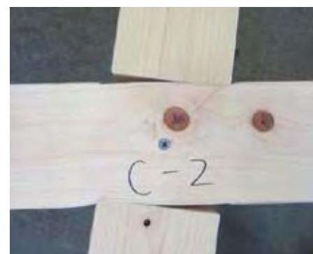
写真2. 相欠き仕口部のめり込み
