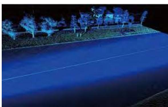
図1. 3次元点群データ (交通総合試験路)
