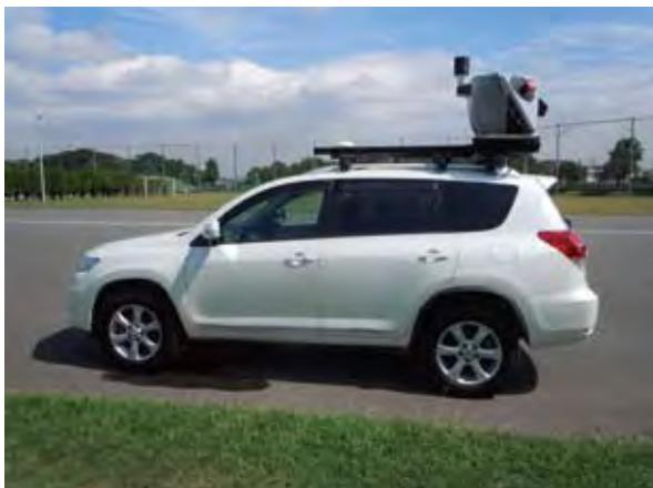
写真1. モバイルマッピングシステム (Trimble MX8)
