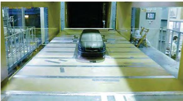
図1 風洞測定部内に設置した自動車模型と専用の地面板
