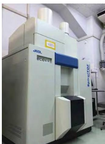
図1 MALDI-TOF-TOF質量分析装置
