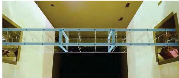
図1 辺長比2角柱模型と架台
