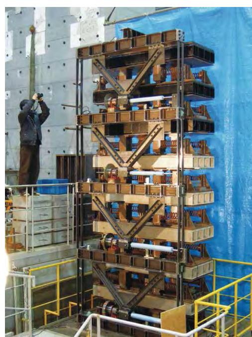
図2 D.M.付制震アウトフレーム連結システム試験体
