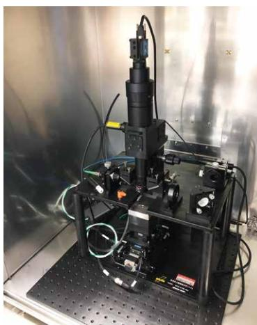
図1 CRESTのプロジェクトで試作した表面電位計測システム
