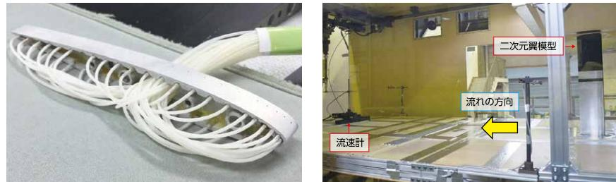
図1 二次元翼模型（表面圧力計測部）と後流渦の計測の様子
