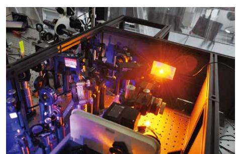
図2 フェムト秒パルスレーザー利用全光型超高速磁化現象計測システム
