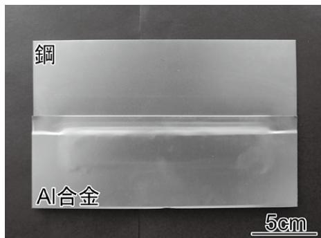
図1 アルミニウム合金／鋼異材接合材の外観
