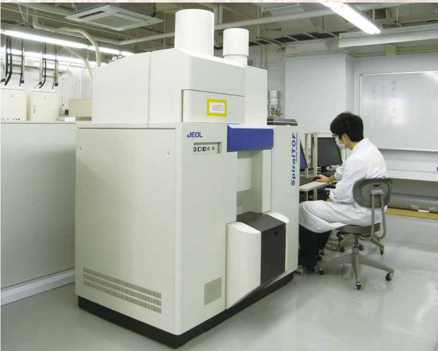
材料創造研究センター 飛行時間型質量分析装置
