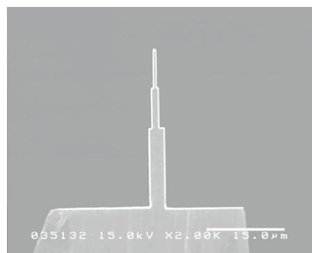
図2 先端材料科学センター所有の集束イオンビーム加工装置 (FIB) を用いて微細加工した電極探針例
