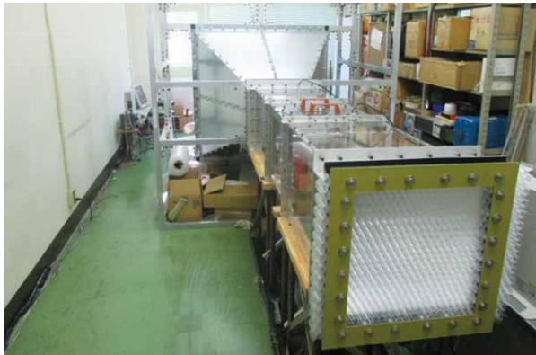
図1 OWC型波力発電模擬装置
