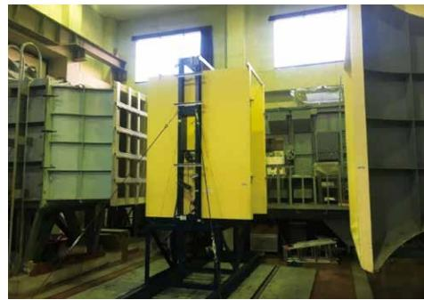
図1 2次縮流部と格子を設置した風洞
