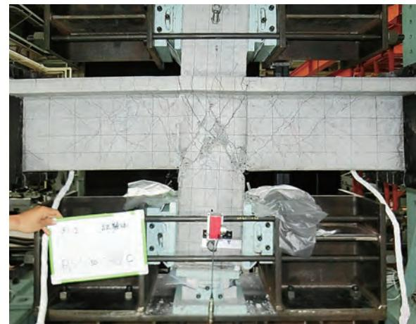
写真1 スラブ付柱梁接合部試験体
