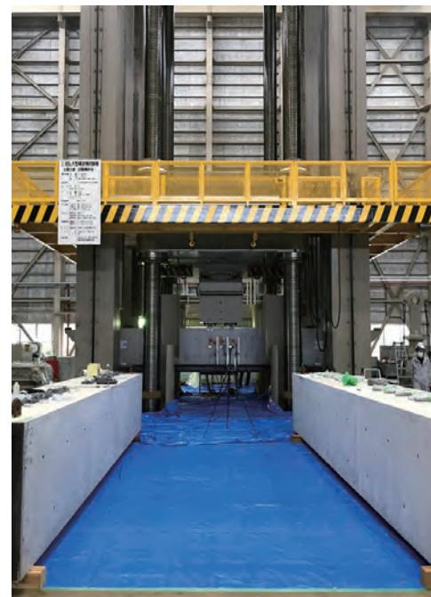
写真1 RC造梁試験体と実験風景
