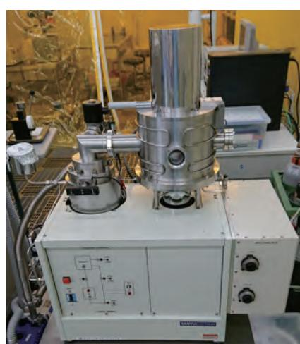
図1 RFマグネットロンスパッタリング装置
