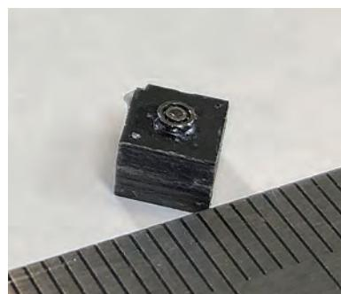
図1 ミリメートルスケールのシリコンエアタービン
