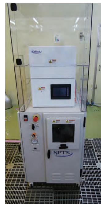
図2 新たに導入する犠牲層エッティング装置
