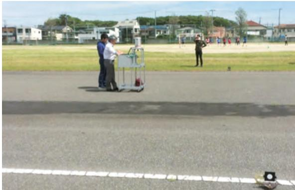
写真-1 地上型レーザースキャナーによる計測状況
