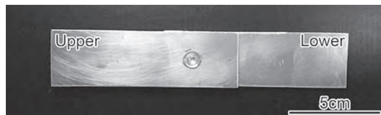
図1 摩擦攪拌スポット接合したアルミニウム合金接合材の外観
