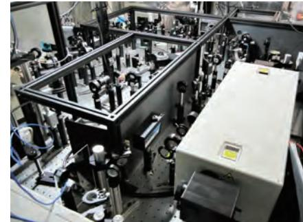
図2 フェムト秒パルスレーザー利用全光型超高速磁化現象計測システム
