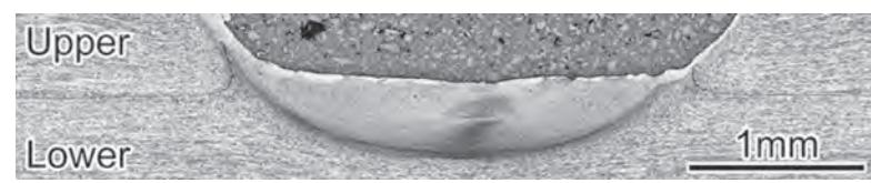
図2 接合界面断面の光学顕微鏡像
