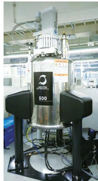
図1 導入された核磁気共鳴(NMR)装置
