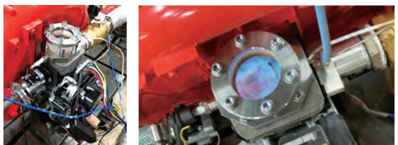
図2 回転数8000 rpm程度の高速域での燃焼を可視化できる超高速可視化エンジン
