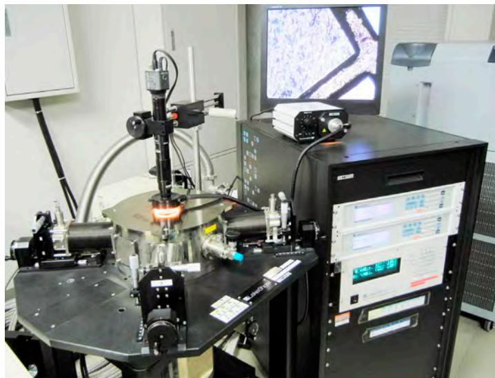
多環境プローバー（温度可変強磁場下精密電気特性計測装置）
