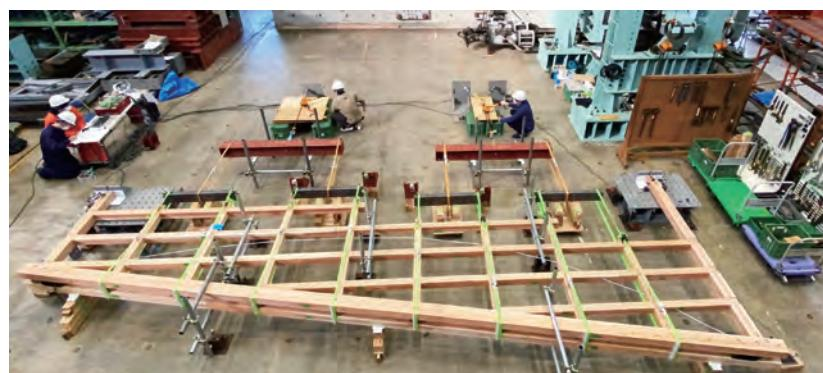
図2 木造トラスの実大載荷実験
