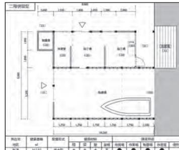
図2 実測調査に基づき作成した舟小屋の平面図
