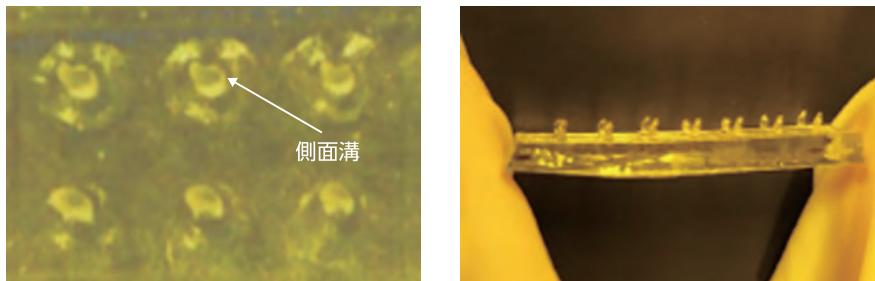
図1 マイクロニードル(先端側から見た状態(左)と側面)
