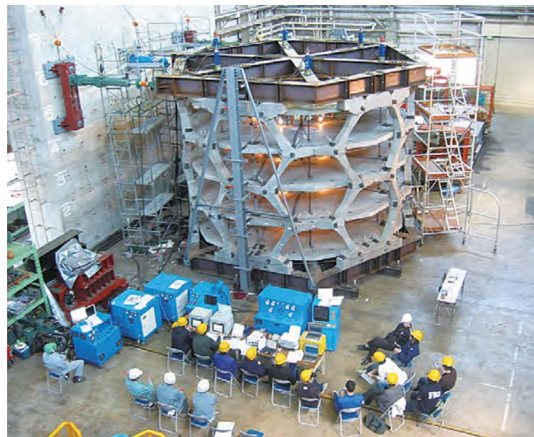
ハニカムチューブPC構造立体架構の実験状況
