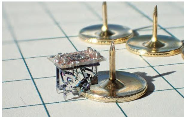
図1 開発を進めているマイクロロボット
