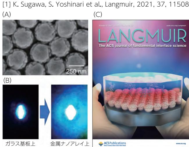
図1. (A) 光閉じ込め銀ナノアレイのSEM画像、(B) アップコンバージョン発光の様子、ガラス基板上と比して銀ナノアレイ上では著しく増幅されたアップコンバージョン発光が視認できる。(C)アメリカ化学会誌に採択された論文のSupplemental cover. Adapted with permission from Ref. 1. Copyright 2021 American Chemical Society.
