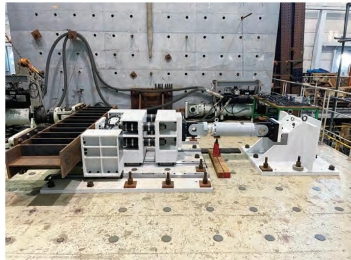
図1 実大オイルダンパーの性能試験
