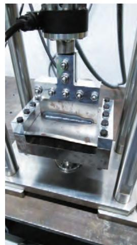
図1 アーク溶接両側隅肉溶接T字継手疲労試験装置
