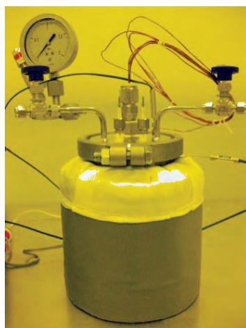
図1 高圧水蒸気中での陽極酸化装置
