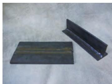
図2 左：つき合わせ溶接 右：すみ肉溶接
