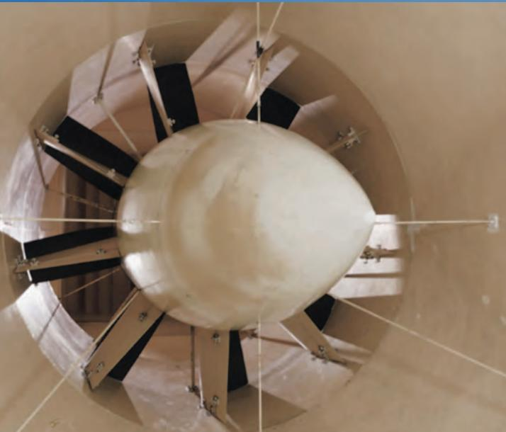
空気力学研究センター 径3.4mの軸流型送風機
