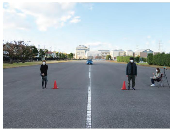
図1 車両接近報知音の認知距離測定実験の様子
