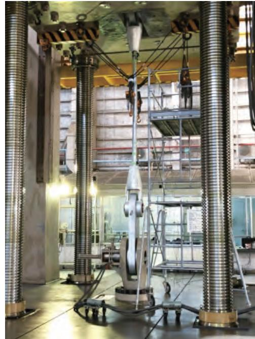
図1 ロックドコイルロープの静的引張試験状況
