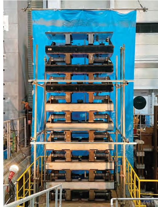
図1 新たなTMDシステムを付加した9層せん断モデル試験体
