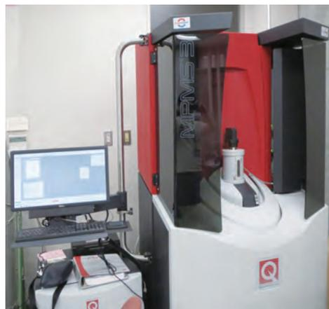
図2 無冷媒型SQUID-VSM磁気特性測定システム
