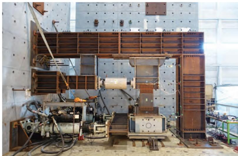
M-CK型実大ダンパーのリアルタイムオンライン応答試験
