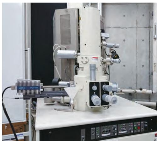
図 走査電子顕微鏡及びエネルギー分散型X線分光分析装置 (SEM-EDS)
