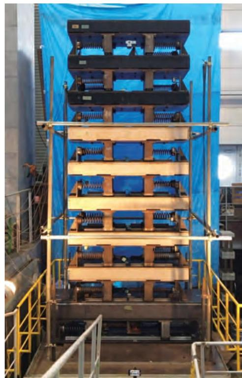
M-CK型システムを用いた9層せん断モデル試験体
