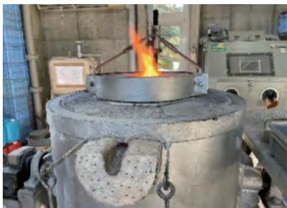
図1 可傾式ルツボ炉
