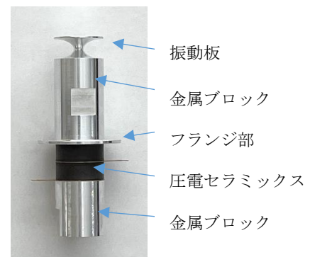
写真：BLT 型超音波エミッタ
