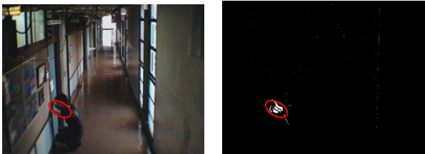
(a) 元画像 (b) フレーム間差分画像 図 4 ピッキング時の画像
