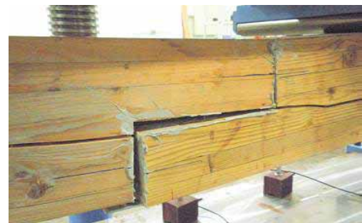
図 5 腰掛継手の付け根からのひび割れ
