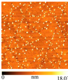
図 2 二枚の c 面 LNO 基板の表面同士を重ねて温度 700^\circ\text{C} で 12 時間熱処理した基板の表面像( 5 \times 5 \mu\text{m}^2 )
