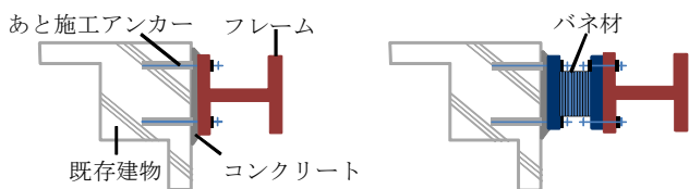
Figure1-1 接合部略図 (左：従来 右：制震改修)
