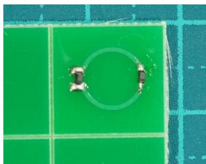
図2:実際に作製した SRR (バイアス回路なし)。
