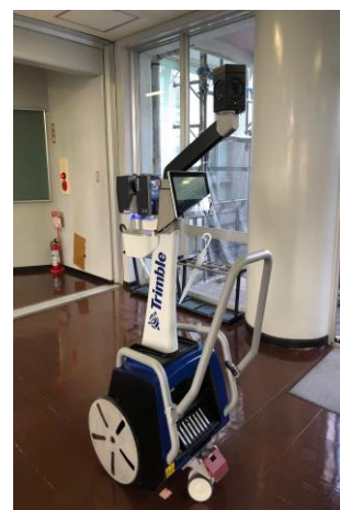
Figure 1. TIMMS 屋外の走行実験ではニコン・トリニブル社製のTrimble MX9を使用した. Trimble MX9は360°カメラ, レーザスキャナ, GNSSアンテナ, 走行距離計, 慣性航法装置で構成されている. 1秒間に100万点の点群が取得できる高性能なシステムである. 以上の2機種とも色, 反射強度値, 高さ情報を取得できる.
